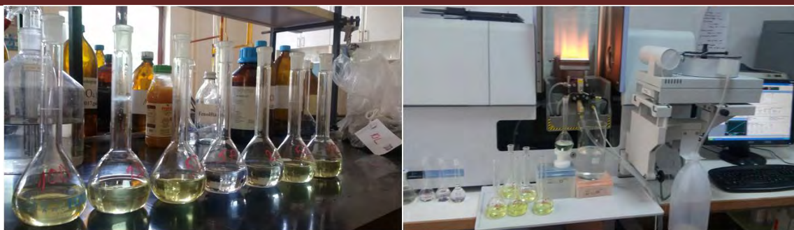
Slika 3: Pripremljeni uzorci (lijevo) i analiza na AAS-u (desno) (Autori: Medić E., Abdić J.,2018.)
